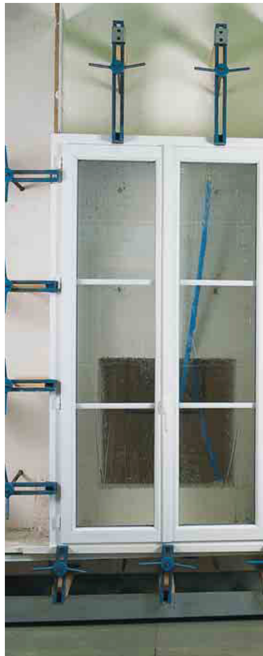
Test d'une menuiserie à l'air, à l'eau et au vent.
