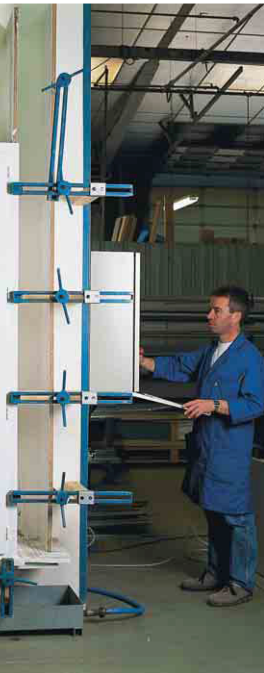
Test de résistance des soudures.
